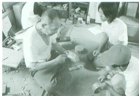
▲「めざし」を使って曲げた板を縫い合わせる
