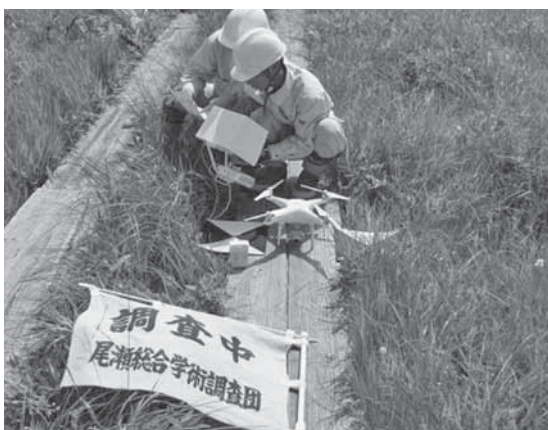
▲ ドローンによる空撮測量の準備中 2017.9.5 中田代
