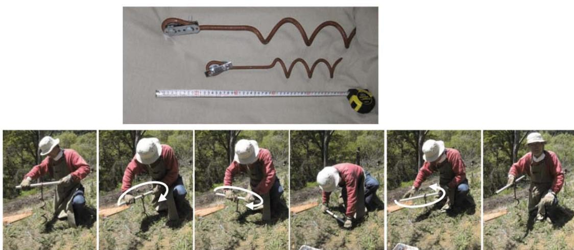
図 6-4 スクリュー杭（市販品事例）、回転差しこみと逆回転抜き取りが容易
