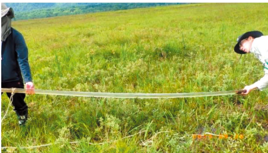
図2. パイプにより採取した動きの田代の下の地下池塘の水（NY6-Y、2020年8月）。パイプの長さは3 m、右が底。永坂ほか（2022）。
