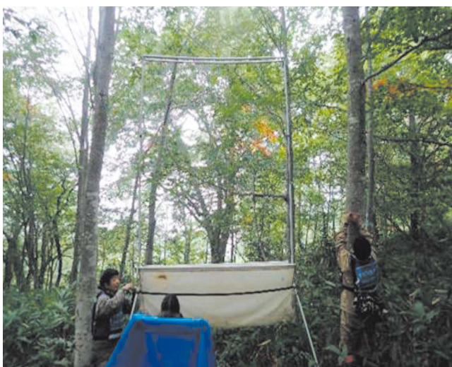
図2. ハープトラップ。四角い枠に楽器のハープのようにテグスがはってあり、飛んできたコウモリはそこに当たって落ち、下の袋に入る。片品村鳩待峠。
